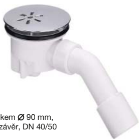
TEMPOPLEX extraploché odtok pro sprchy s odtokem Ø 90 mm, stavební výška 60 mm, vyjímatelný zápachový uzávěr, DN 40/50 634100 | 2 193 Kč
