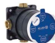
PODOMÍTKOVÉ TĚLESO FLEXX.BOXx pro zabudování do stěny, bez ovládací jednotky, s proplachovou soupravou 88011 | 2 716 Kč
