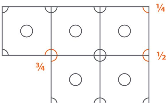
Pro vyrovnání dlažby oproti spádovanému podkladu je potřeba podložky skládat na sebe. Pro přesné vyrovnání se přidávají k pevným terčům rektifikační podložky výšky 3 mm.
