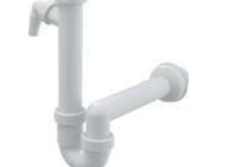
PT1008150 SIFON DŘEZ A VÝLEVKA; plastový trubkový s převlečnou maticí a přípojkou DN 50, bílá
