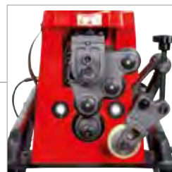
Revolverová hlava s integrovanými přítlačnými kolečky
