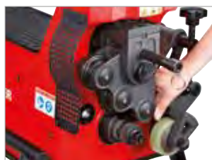
Trojnásobné nastavení velikosti přítlačných koleček, bez použití nářadí
