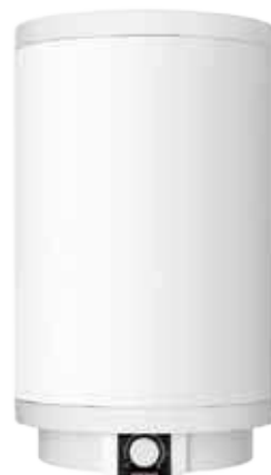
NÁSTĚNNÝ ZASOBNÍKOVÝ OHŘÍVAČ VODY PSH 120 TREND rozměry (v × p): 1 178/Ø 510 mm, příkon 2 kW, 230 V, ocelová smaltovaná nádrž 120 l 232084 | 11 253 Kč
